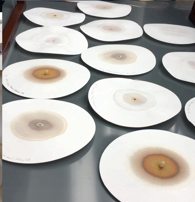
**Une solution de nitrate d'argent doit d'abord être mis dans les papiers filtrants**
